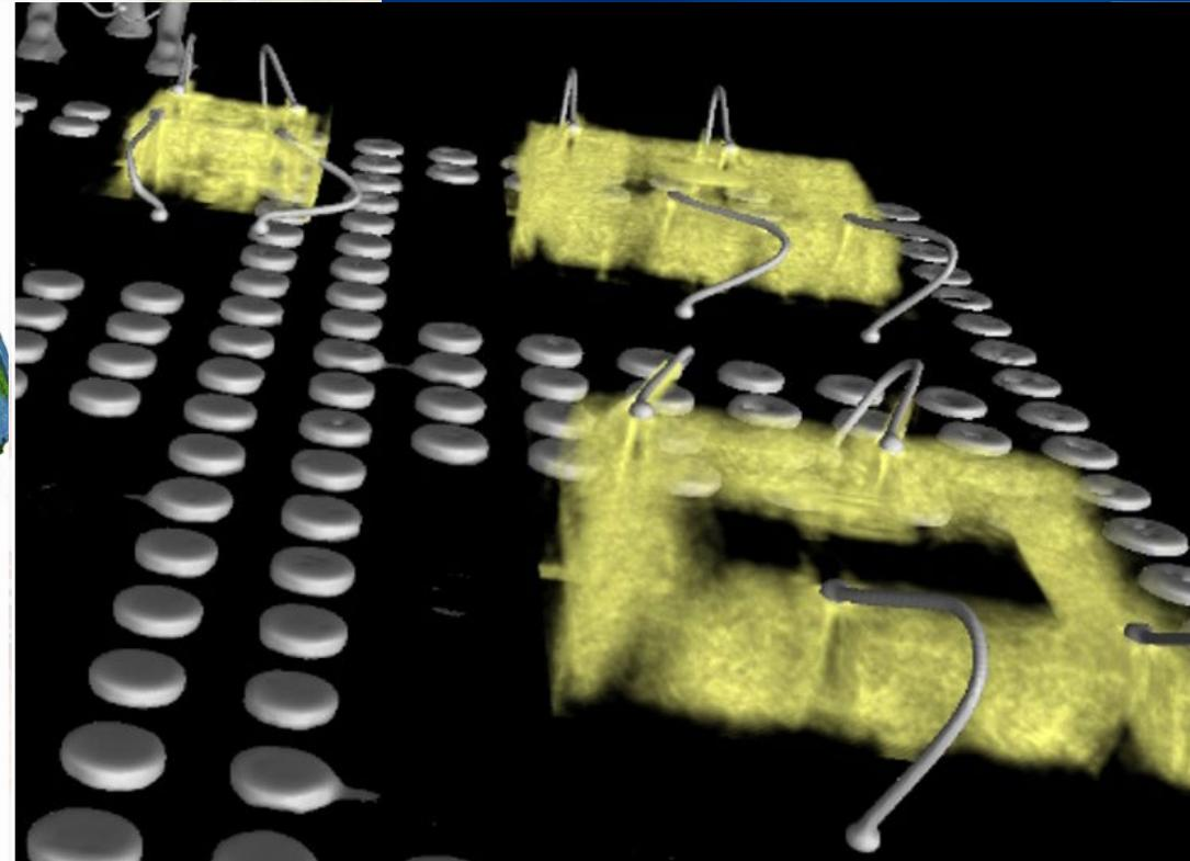
Zerstörungsfreie Qualitätssicherung und Fehleranalyse für die Mikroelektronik
