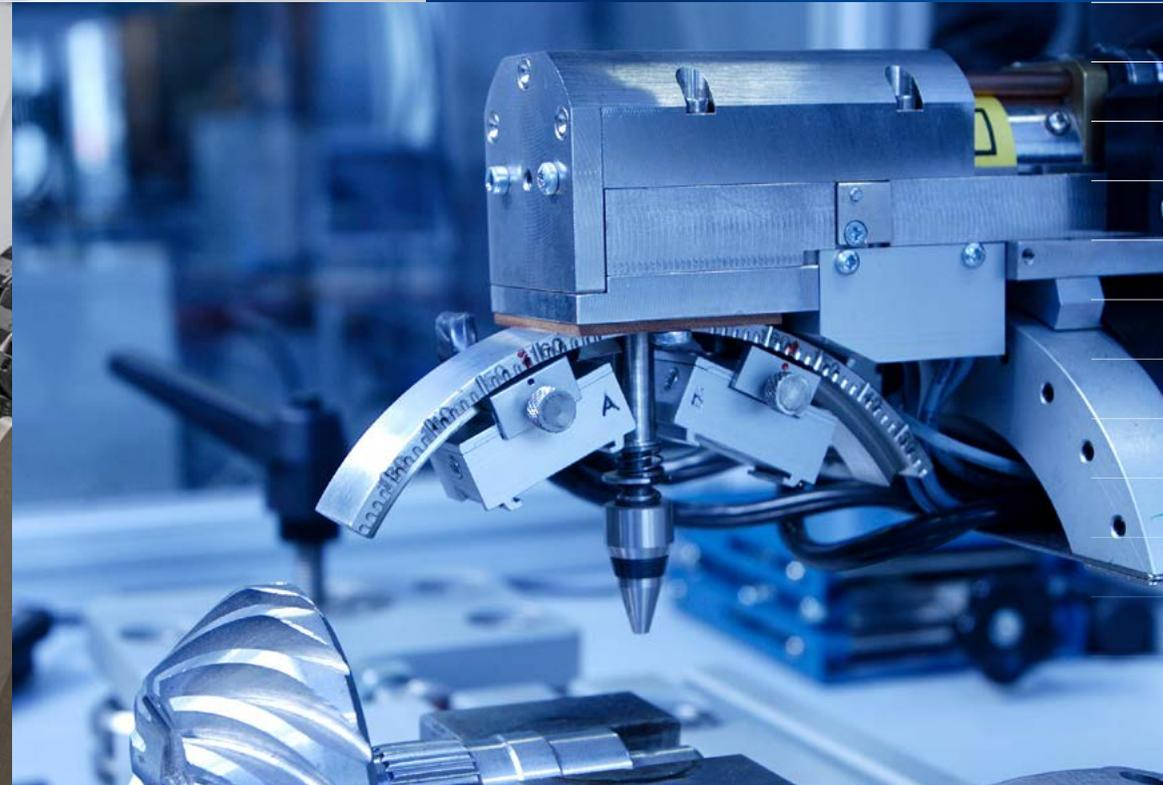
Röntgenographische Bestimmung von Phasenaufbau und Strukturparametern bei Raumtemperatur
