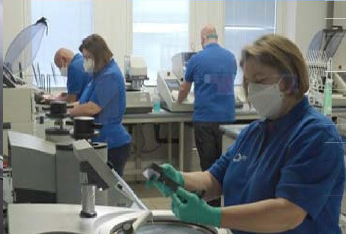
Grobzuschnitt, Feintrennen, mechanische Probenherstellung und Präparation von metallographischen Schliften.
