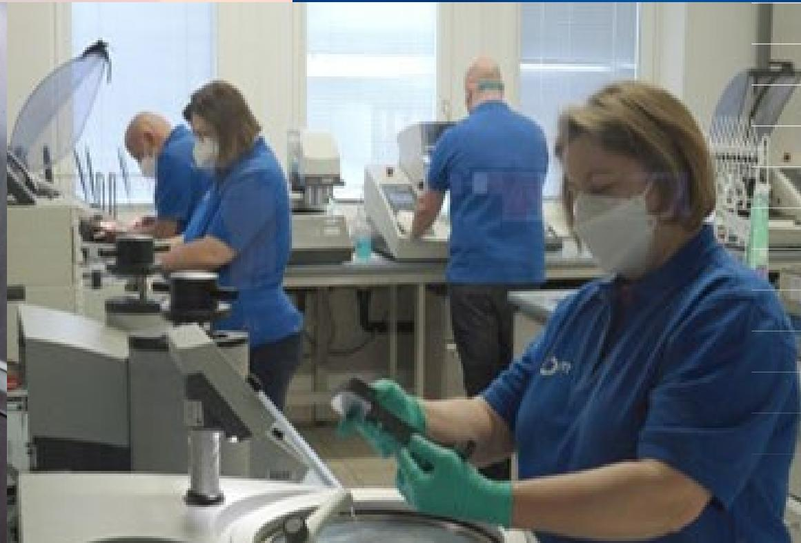
Grobzuschnitt, Feintrennen, mechanische Probenherstellung und Präparation von metallographischen Schliffen.
