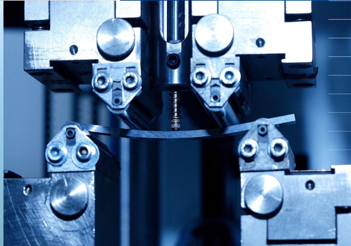
Bestimmung von mechanischen Werkstoffkenngrößen für niedrig- bis hochfeste Werkstoffe unter Zug, Druck und Biegung.
