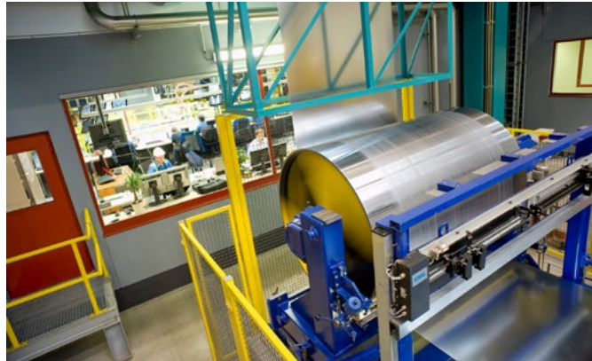
Blick auf den Steuerstand der Feuerverzinkungsanlage. Im Vordergrund sieht man das Stahlband mit Umlenkrolle. Bild © voestalpine Stahl
