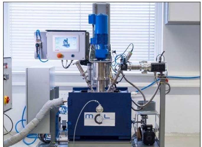
Die neu entwickelte Cryomühle; Bild: MCL
