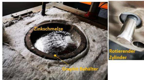
Bild 2: Foto des RDE Versuchsaufbaus mit der Zinkschmelze und dem rotierenden Zylinder. Bild: MUL-NEM
