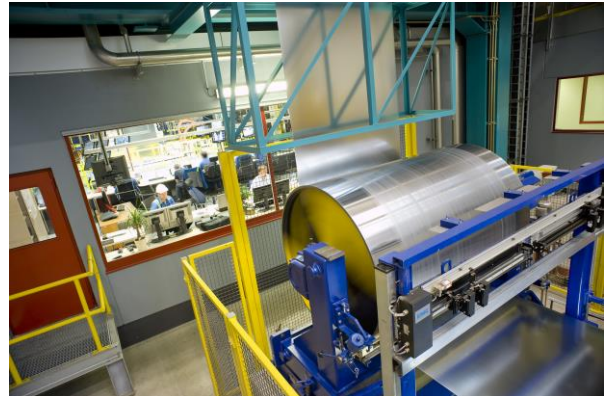
Blick auf den Steuerstand der Feuerverzinkungsanlage. Im Vordergrund sieht man das Stahlband mit Umlenkrolle. © voestalpine
