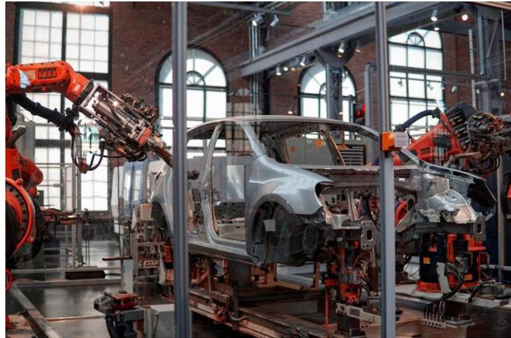
Bild 1: Von Robotern punktgeschweißte Karosserie
