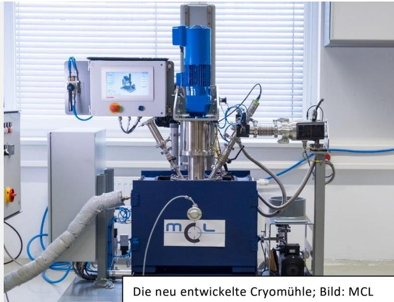
Die neu entwickelte Cryomühle; Bild: MCL
