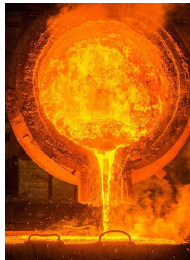
Transportgefäß für flüssigen Stahl im Einsatz ©photollurg-stock.adobe.com
