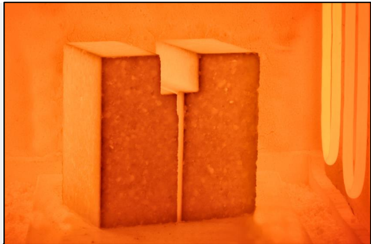
Probekörper für Keilspaltuntersuchungen bei 1300 °C (Bild: Lehrstuhl für Gesteinshüttenkunde, Leoben)
