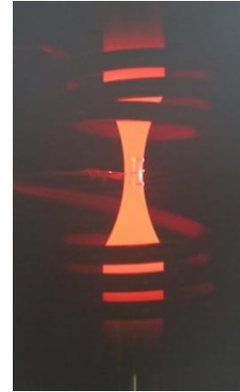
Abb. 1: Laborprobe aus dem Werkzeugwerkstoff WC-Co Hartmetall die bei 800°C in einem Vakuum uniaxial belastet wird.
