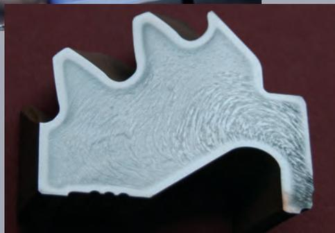
Makroätzung an einem Zahnradquerschnitt
