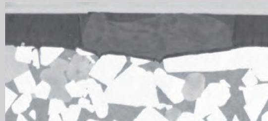
FIB Schnitt durch einen Beschichtungsdefekt
