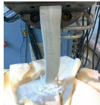
Herstellung von MDF im Compounder
