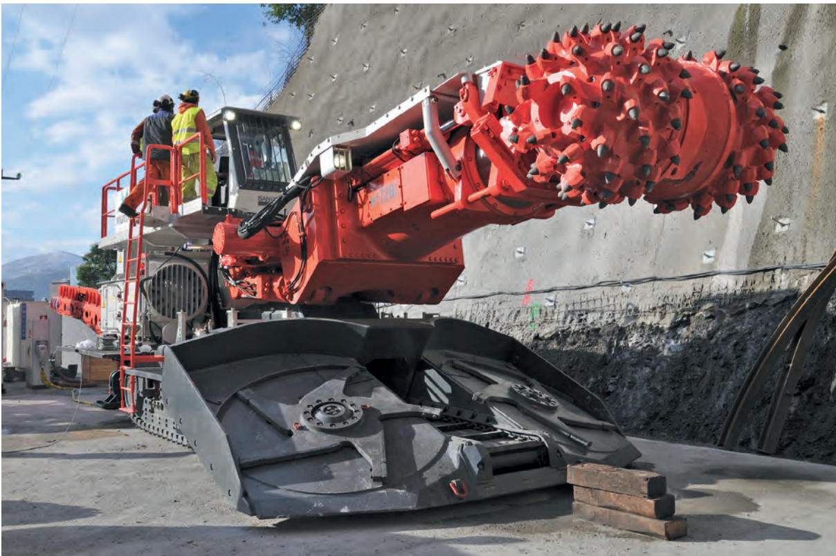
Eine Teilschnittmaschine, wie sie im Tunnelbau zum Einsatz kommt (© Sandvik Mining and Construction)
