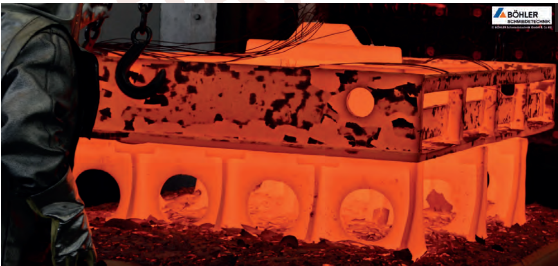
Abb. 2: Wärmebehandlungsversuch mit Thermoelementen an einer Turbinenscheibe nach dem Schmieden (© Böhler Schmiedetechnik)
